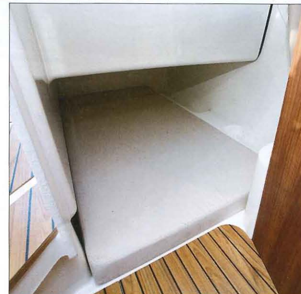
Le chantier a réussi l'exploit d'installer une seconde cabine. Celle-ci est un peu étroite, mais elle comprend un couchage pour une personne (1,88 x 0,90 m).
