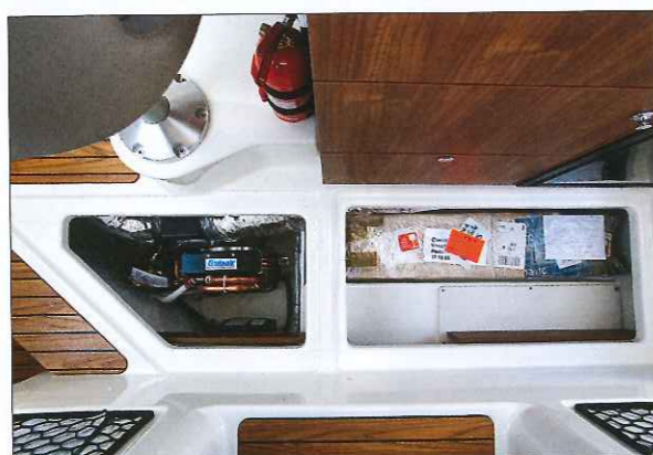
Le plancher intérieur comporte des coffres de rangement très pratiques. Celui situé sur la gauche accueille la climatisation (en option).
