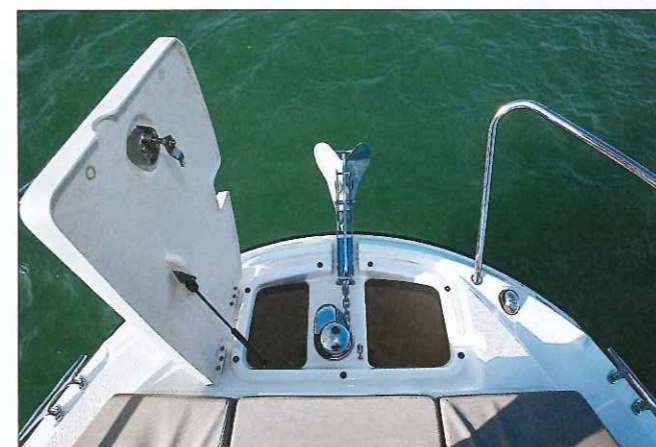
La baille à mouillage est d'une belle profondeur. Le guindeau électrique est en option, mais il figure dans le pack de l'Édition Smart.
