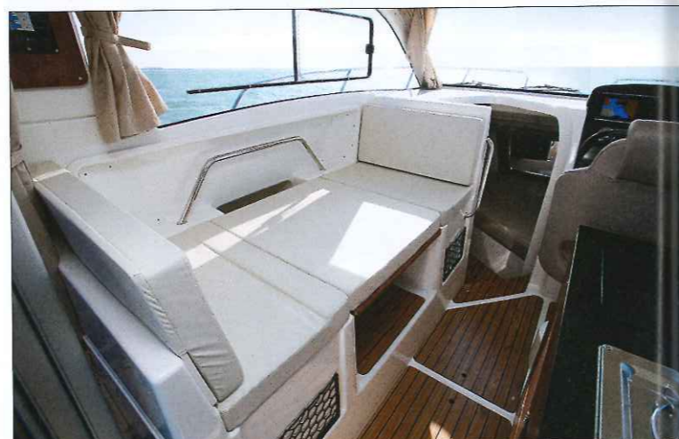
En abaissant la table du carré de la timonerie, on obtient un couchage d'appoint parfait pour un enfant, car il ne mesure que 1,59 mètre de long.
