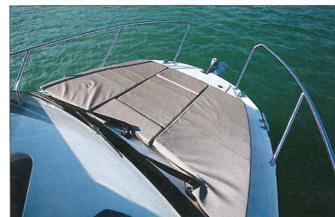
D'excellente qualité, la sellerie du grand bain de soleil avant (en option) est fixée sur des rails, un système qui permet un bon maintien.
